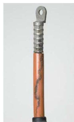
Образец, поврежденный трекинговой дорожкой
